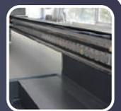
5. Upgrade de 1 para 2 guias lineares horizontais para suportar o carro de impressão, sistema anti-interferência aperfeiçoado, aumentando ainda mais a precisão de impressão em alta velocidade e garantido vida útil prolongada dos componentes.
